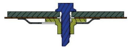
3 Die Schraube wird in das Gewinde gedreht.
